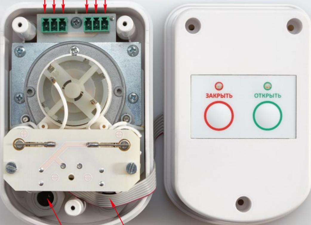
Два места кабельного ввода в корпус электропривода
