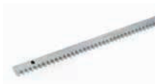
Оцинкованная зубчатая рейка 30x12 мод. 4 с механическими креплениями (в упаковке 4 м)
